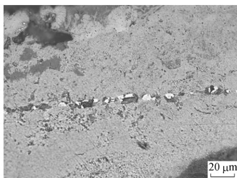
图 4 M27:391 铁刃中的夹杂物变形拉长
