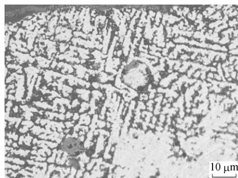
图 7 M27:970 铜戈的铸造的 \alpha+(\alpha+\delta) 树枝晶组织
